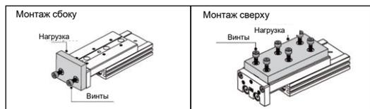
2.2. При монтаже нагрузки затягивайте винты с моментом затяжки в пределах допустимого диапазона. Используйте винты минимум на 0,5 мм короче максимальной глубины резьбы, чтобы не допустить их контакта с направляющей, т.к. это может привести к поломке привода.
